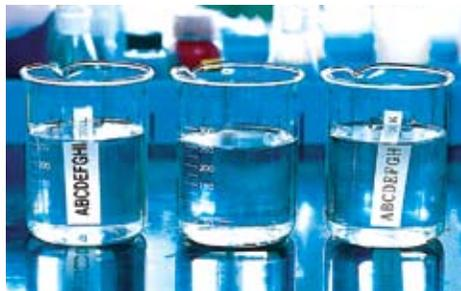
**Résistance à l'eau et aux substances chimiques :** après 2 heures d'immersion dans de l'eau et dans diverses substances chimiques, le texte des étiquettes collées sur des lamelles de verre reste intact.
