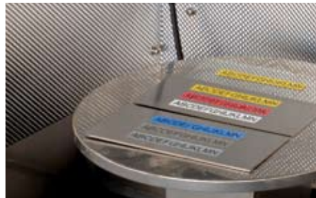
Nicht verblässend: Laminierte Etiketten wurden in eine Bleichkammer gegeben, die ein Jahr Sonneneinstrahlung simuliert. Der Text wurde nicht beeinträchtigt.
