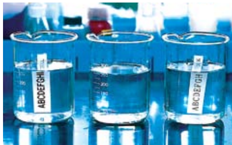
Wasser- und chemikalienabweisend: Glasplatten mit laminierten Etiketten wurden zwei Stunden lang in Wasser und Chemikalien getaucht. Der Text blieb klar lesbar.
