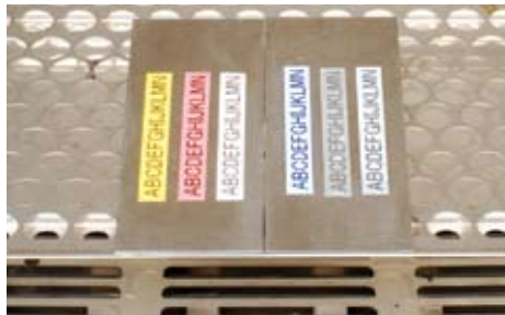
Temperaturbeständig: Laminierte Etiketten wurden 240 Stunden lang Temperaturen zwischen -80 C bis +150 C ausgesetzt, ohne Auswirkungen auf den Text.
