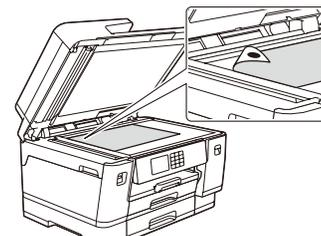
Novietojiet uz skenera stikla pielāgošanas lapu ar skatu uz leju. Pārliecinieties, ka melnais punkts atrodas skenera stikla augšējā kreisajā stūrī.
