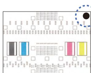
Sekojiet instrukcijām LCD ekrānā, lai izdrukātu pielāgošanas lapu. Melnā punkta atzīme atrodas lapas augšējā labajā stūrī.
