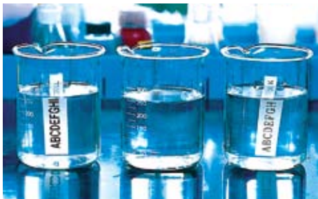
Veden ja kemikaalien kestävyys: laminoidut tarrat kiinnitettiin lasilevyihin, jotka upotettiin veteen ja useisiin erilaisiin kemikaaleihin kahden tunnin ajaksi. Teksti säilyi vahingoittumattomana.
