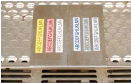
Ääriämpötilojen kestävyys: laminoidut tarrat altistettiin -80 °C...+150 °C lämpötiloille 240 tunnin ajaksi. Teksti säilyi vahingoittumattomana.
