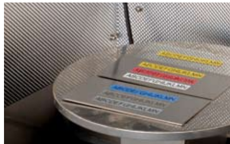
Modstandsdygtig over for sollys: Det havde ingen indvirkning på teksten, da laminerede labels blev anbragt i et falme fremkaldende kammer til simulering af et år i solrige omgivelser
