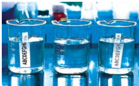
Modstandsdygtig over for vand og kemikalier: Glasplader med påsatte laminerede labels blev nedsænket i vand og diverse kemikalier i to timer. Det havde ingen indvirkning på teksten
