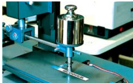
Ridsebestandighed: Det havde ingen indvirkning på teksten, at der 50 gange blev kørt en slibemaskine på 1 kg over de laminerede labels
