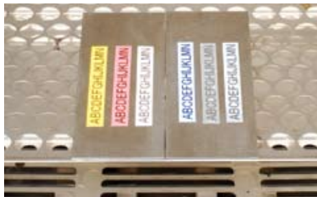
Temperaturbestandighed: Laminerede labels blev udsat for temperaturer fra -80 C til +150 C i 240 timer uden indvirkning på teksten
