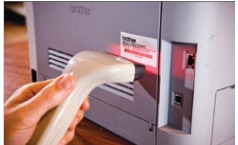
Sluit een barcodescanner aan op de seriële poort van de printer om labels rechtstreeks via de TD-4000/TD-4100N af te drukken*
