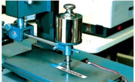
Schuurbestendig: gelamineerde labels werden 50 keer met een schuurapparaat van 1 kg bewerkt, en de tekst bleef onaangestast
