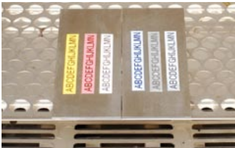
Temperatuurbestendig: gelamineerde labels werden gedurende 240 uur onderworpen aan temperaturen variërend van -80C tot +150C en de tekst bleek onaangestast
