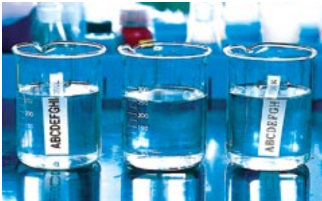
Bestand tegen water en chemicaliën: glasplaatjes met daarop gelamineerde labels werden twee uur lang in water en diverse chemicaliën ondergedompeld. De tekst bleek onaangestast
