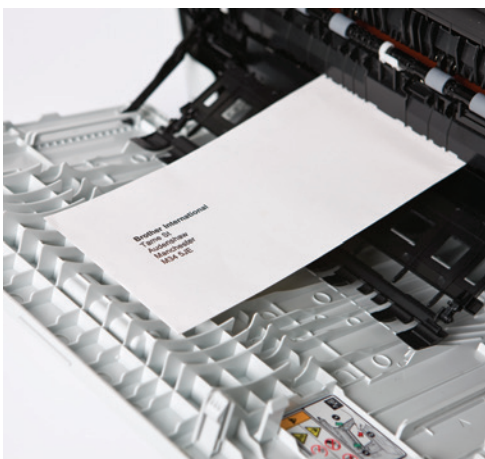
Print enveloppen en dikker papier m.b.v. het rechte doorvoerpad
