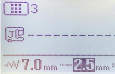
Sélectionner le point droit, largeur 7 mm (aiguille à droite), coudre.
