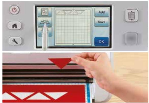
**Conseil** La fonction de disposition automatique vous permet d'économiser du papier en calculant automatiquement la disposition la plus efficace pour découper plusieurs pièces.
