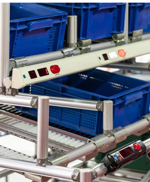
Les méthodes « Pick-by-light » et « Put-to-light » sont basées sur des signaux lumineux fixés aux rayonnages des entrepôts, qui indiquent le bon compartiment de stockage au préparateur.
