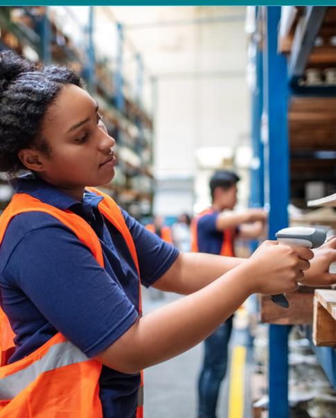
Avec la méthode « Pick-by-scan », un scanner manuel est utilisé pour enregistrer à la fois l'étiquette de code-barres située sur l'étagère de stockage et celle de l'article à ramasser. Cette technologie, également connue sous le nom de saisie par codes-barres (« Pick-by-barcode ») est une solution éprouvée et relativement peu coûteuse pour la préparation de commandes sans papier.
