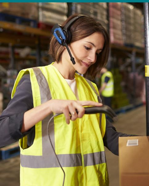
La technologie de « voice picking » ou de guidage vocal permet au préparateur de commandes de recevoir des informations via un casque, ses deux mains étant libres pour effectuer le prélèvement des marchandises.
