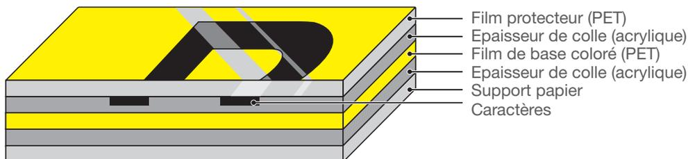
Les rubans laminés TZe Brother se composent de six couches permettant d'obtenir des étiquettes fines mais extrêmement résistantes. Les caractères, imprimés par transfert thermique, sont intercalés entre deux couches protectrices de film polyester. Le résultat est quasiment indestructible et peut supporter les conditions les plus rudes.
